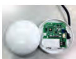
В 2019 г для всех типов полупромышленных кондиционеров можно опционально заказать и установить модуль SMART PORT. Он предназначен для организации управления через интернет посредством локальной сети Wi-Fi. модуль подключается к плате управления внутреннего блока и включает в себя интерфейсную плату и модуль SK-102 с разъемом USB, аналогичный к применяемым в настенных сплит-системах.
