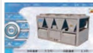
Графический интерфейс управления чиллером модели RHAЕ (есть русский язык) реализованный на планшетной панели, он позволяет задавать рабочие параметры машины и осуществлять мониторинг работы всех основных компонентов чиллера или группы чиллеров.
