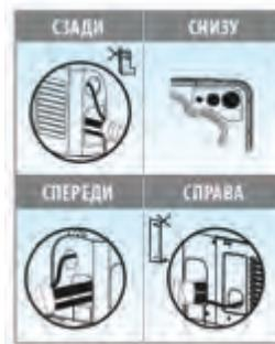
4 варианта подключения труб и проводки
