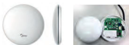
В 2019 г для всех типов полупромышленных кондиционеров можно опционально заказать и установить модуль SMART PORT. Он предназначен для организации управления через интернет посредством локальной сети Wi-Fi. модуль подключается к плате управления внутреннего блока и включает в себя интерфейсную плату и модуль SK-102 с разъемом USB, аналогичный к применяемым в настенных сплит-системах.
