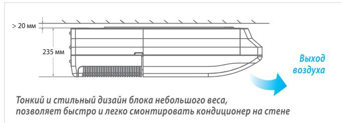
Тонкий и стильный дизайн блока небольшого веса, позволяет быстро и легко смонтировать кондиционер на стене
